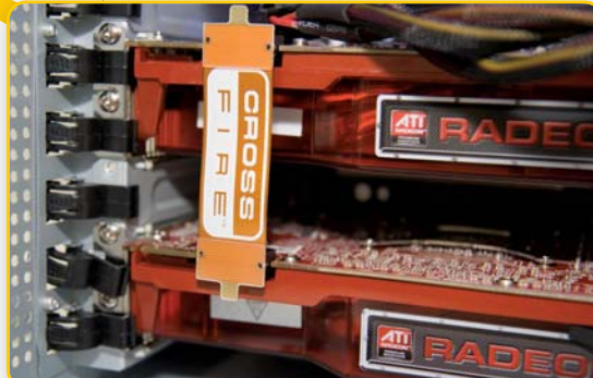
Dôvod ohromnej spotreby a herného výkonu: dve grafiky v zapojení CrossFire
